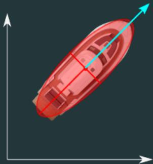
**Assunzione di base:** il vettore velocità è allineato all'asse longitudinale dell'oggetto.
